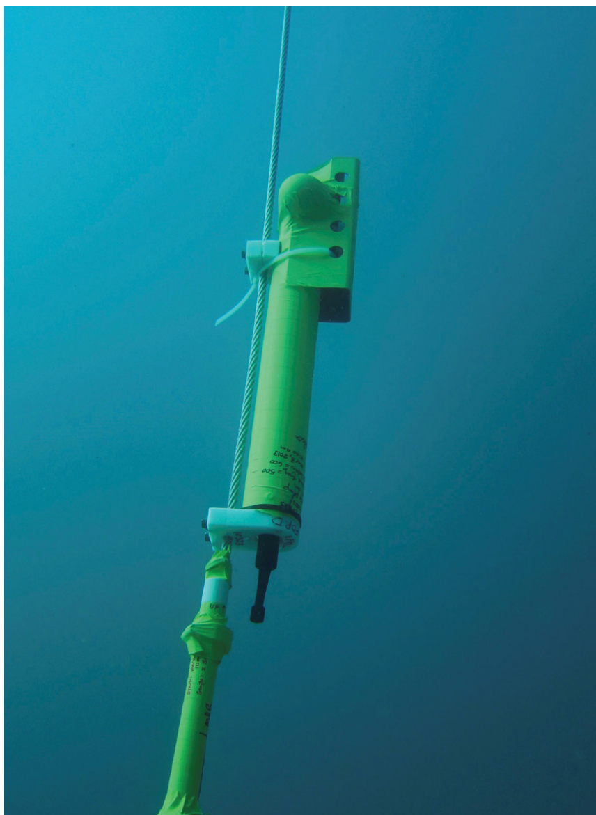
Figura 8. CTD instalado sobre cable de acero inoxidable. Fotografía: Hopkins Marine Station (Universidad de Stanford).
