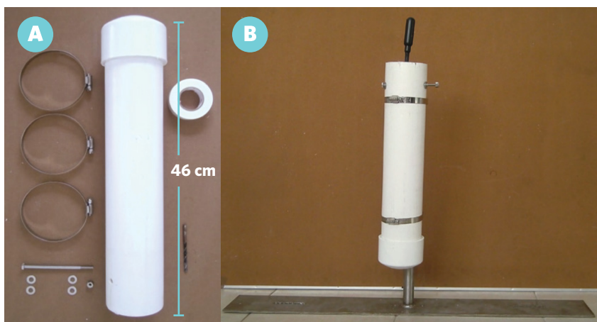
Figura 24. Material de construcción de funda (A), y seguro del sensor acústico colocado dentro de la funda (B). Fotografías: COBI.
