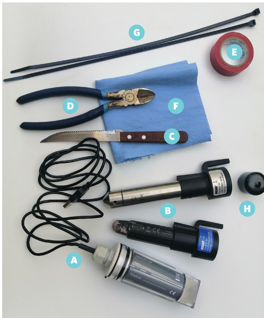
Figura 7. Materiales para mantenimiento de HOBOS. Fotografía: COBI.
