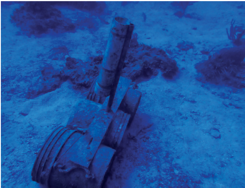
Figura 30. Sistema de fondeo después de 6 meses de haber sido colocado. Fotografía: COBI.
