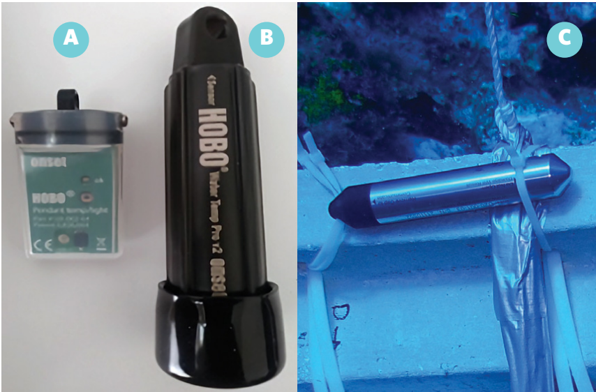
Figura 6. A) Hobo UA-001, B) Hobo U22 y C) Hobo U20. Fotografía: COBI.
