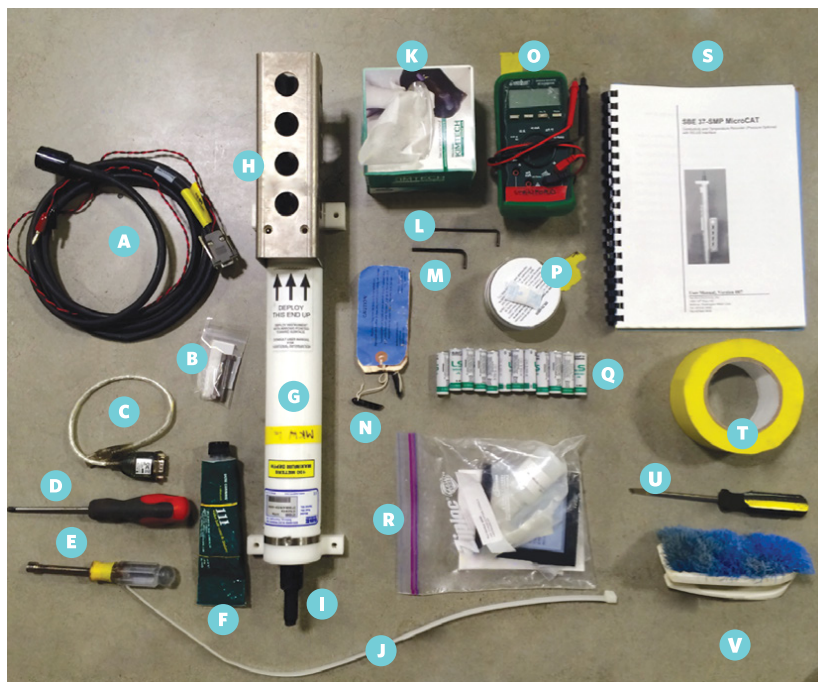
Figura 9. Elementos para instalacion, descarga y reprogramacion de sensor tipo (SBE PN AF24173). Fotografía: COBI.
