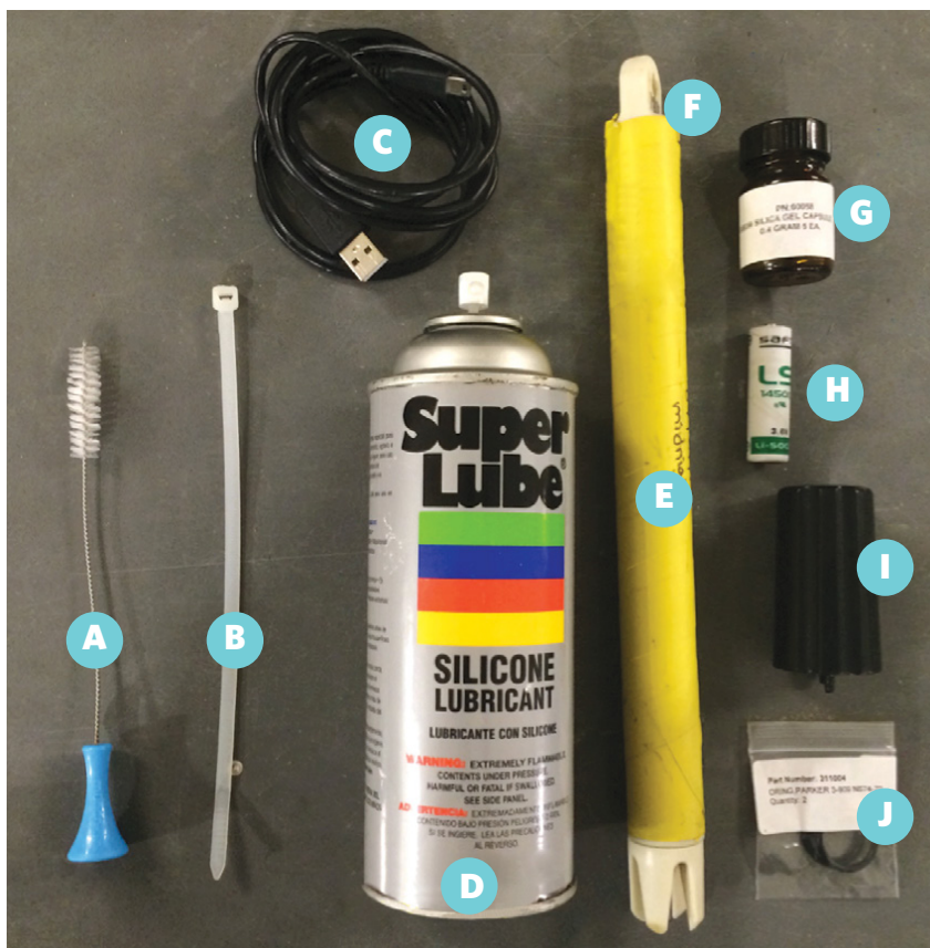
Figura 3. Thermistor SBE-56 y componentes básicos de mantenimiento. Fotografía: COBI.
