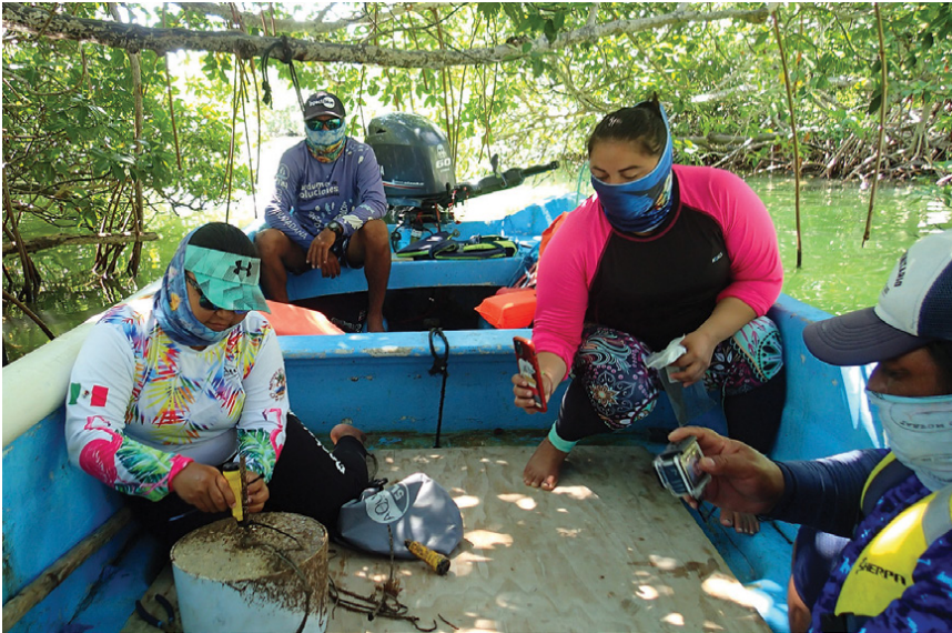
Figura 29. Sistema de fondeo para Hobos, construido con media cubeta de plástico, cemento y varilla galvanizada. Grupo de monitoreo comunitario de Maria Elena y Punta Allen. Quintana Roo. Fotografía: COBI.
