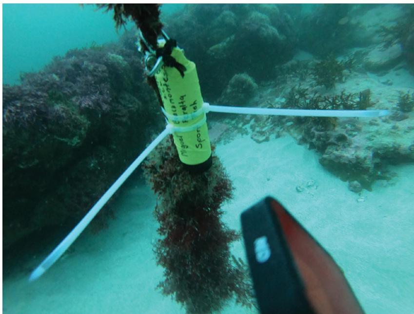
Figura 4. Minidot instalado. Fotografía: Miguel Bracamontes, integrante del grupo de monitoreo comunitario de la SCPP Ensenada, El Rosario B.C.
