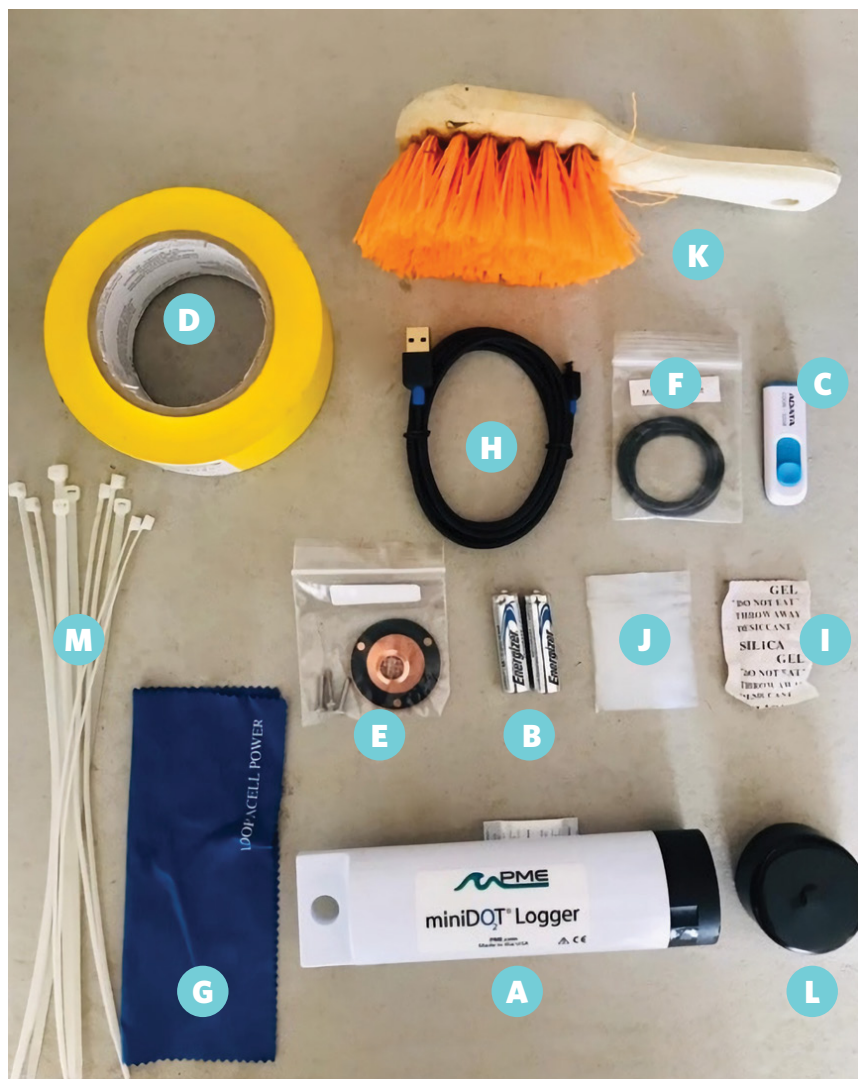
Figura 5. Materiales para mantenimiento de Sensor MiniDOT's. Fotografía: COBI.
