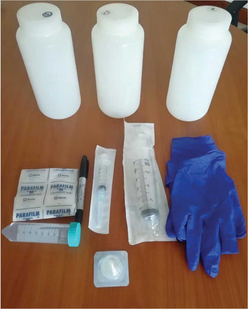
Figura 15. Materiales para proceso de filtrado de agua colectada. Fotografía: COBI.
