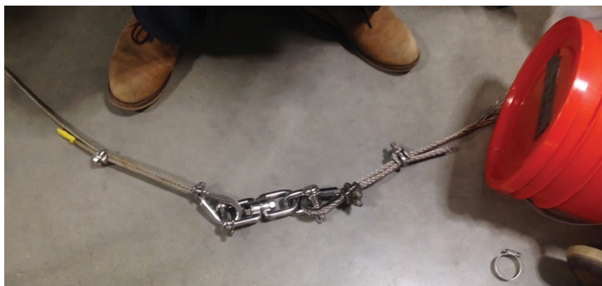
Figura 23. Unión de cubetas a línea principal mediante un destorcedor o girillete giratorio. Fotografía: COBI
