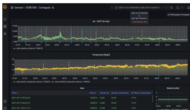
Figura 11. Vista general de datos de pH y temperatura registrados cada diez minutos y medio por el sensor low cost SURCOM-pH almacenados en el sistema de visualización GRAFANA.
