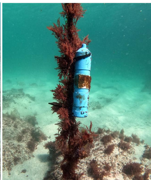
Figura 17. Receptores acústicos instalados en aguas del Parque Nacional das Ilhas Atlánticas mediante A) un anclaje fijo en fondos planos (tipo tornillo) y B) mediante un muerto en fondos rocosos (tipo muerto).
