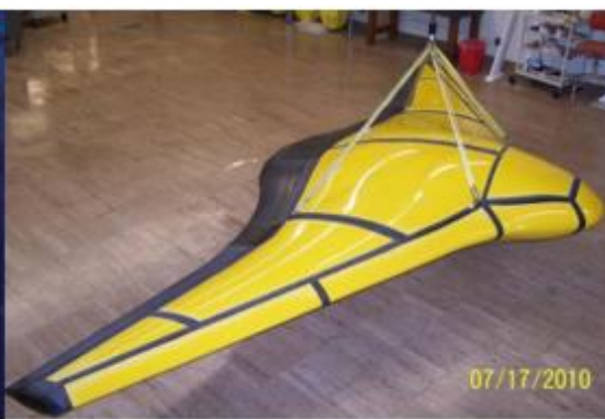
Figura 28. Esquema ilustrativo del funcionamiento de un glider. Extraído de la web de NOC B) Glider tipo torpedo Slocum Seaglider C) Glider tipo Blended-Wing-Body Underwater Gliders Liberdade XRay. Extraído de (Sun et al. 2017)
