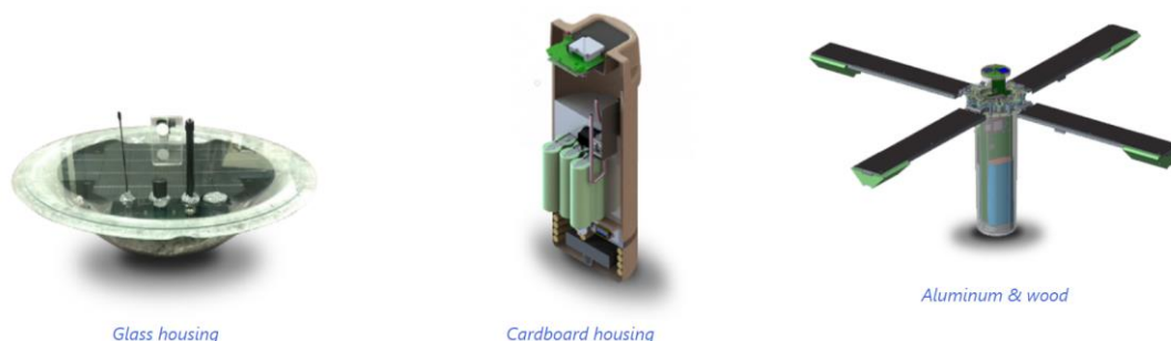
Figura 25. Diferentes prototipos de boyas inteligentes desarrollados dentro del proyecto Ocean of Things
