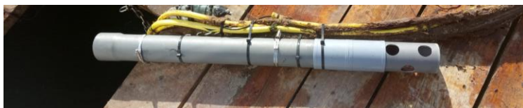
Figura 8. Fotografía del prototipo de sensor de pH, SURCOM-pH, desarrollado por personal científico del IIM-CSIC y fondeado en la estación de Cortegada en el contexto del proyecto Atlazul
